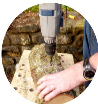
Pour fabriquer le socle avec sa tige, percez au centre de la 1/2 bûche avec votre mèche à bois de 7 mm.
